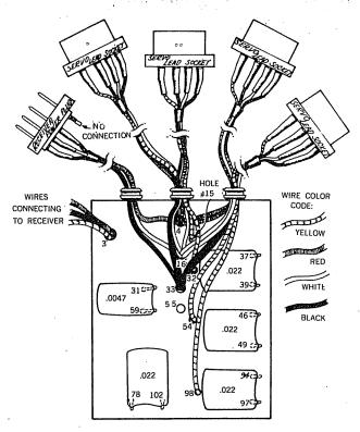
COMPONENT SIDE OF BOARD SHOWING CAPACITORS ONLY & WIRE ROUTING.
