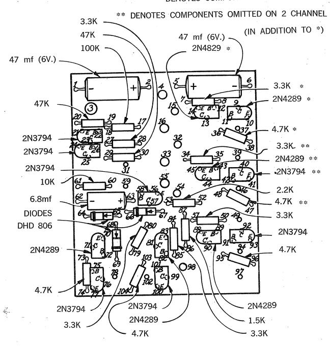
FIG. 1 COMPONENTS (LESS CAPACITORS)
